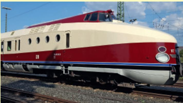
Первый состав дизель-поезда VT 18.16 был представлен на весенней экспозиции в Лейпциге в 1963 году, хотя испытание поезда не провели до конца. Только в мае 1965 года первые поезда отправили в регулярное сообщение. Всего построены восемь составов из 4 вагона (два моторных головных, вагон-ресторан с тремя купе 1 класса и прицепной с купе 1 и 2 классов), два резервных головных вагона и 6 дополнительных прицепных вагонов с купе 2 класса.
